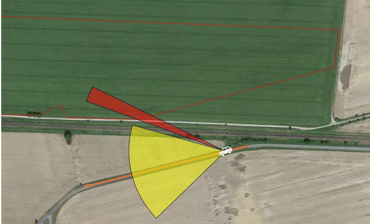
Abbildung 21: Untersucher Abschnitt in Orange, relevanter Sichtfeld in Gelb und Immissionswinkel in Rot
