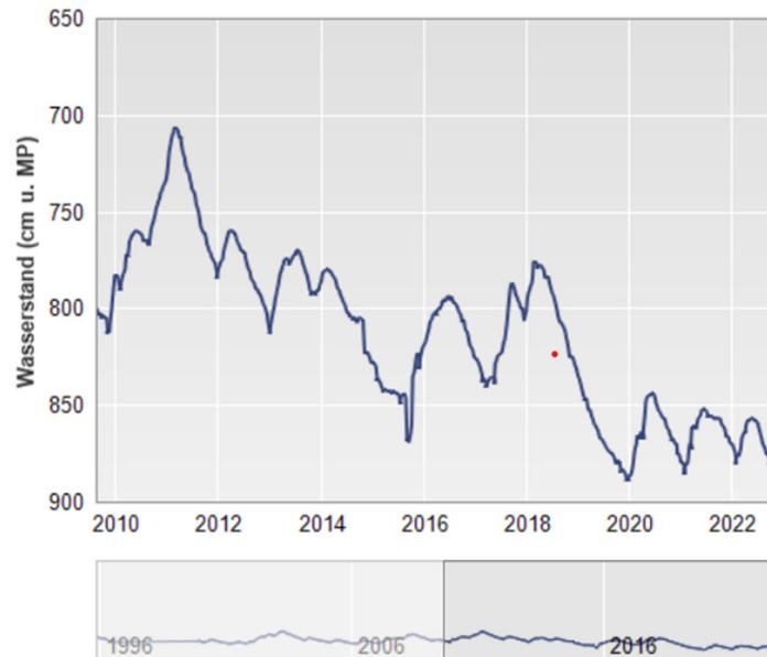
**Abbildung 10: Wasserstandsdiagramm am Grundwassermessstelle Nr. 32330026 bei Maxdorf, Landesbetrieb für Hochwasserschutz und Wasserwirtschaft Sachsen-Anhalt (LHW)**
