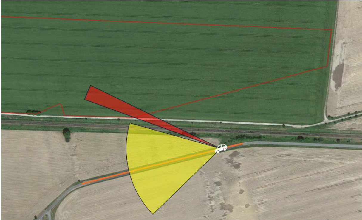
Abbildung 21: Untersuchter Abschnitt in Orange, relevanter Sichtfeld in Gelb und Immissionswinkel in Rot
