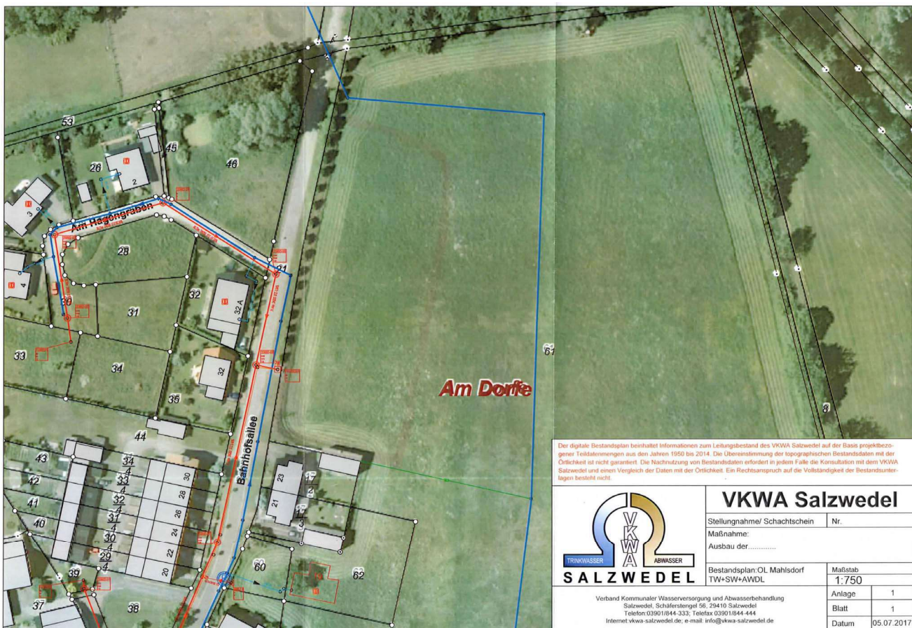
Abbildung 4: Haupttrinkwasserleitung DN 200 des VKWA Salzwedel
